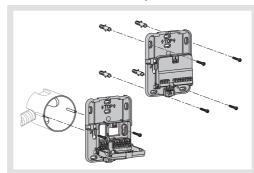
Pour une qualité de régulation optimale, calfeutrez la boîte d'encastrement ou la gaine électrique.
