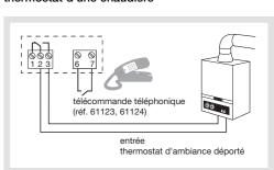
Raccordement du thermostat sur une entrée thermostat d'une pompe à chaleur (PAC) réversible ou non
