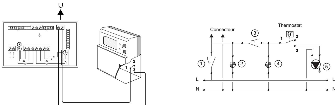
**3 -Thermostat 3 fils (commande de V3V motorisée) -**
