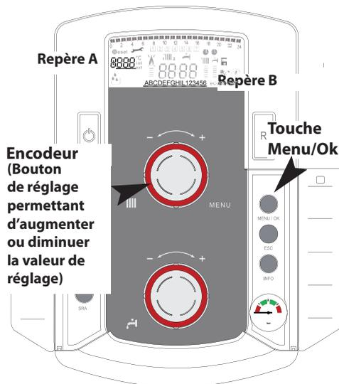
L'accès et la modification des divers paramètres est effectué à travers la touche MENU et l'encodeur 3. Sur l'afficheur sera visualisé la description des menus et des différents paramètres.
