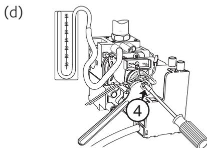
La pression d'alimentation doit correspondre à celle prévue dans le tableau "réglage du gaz" pour le type de gaz pour lequel la chaudière a été conçue. Si les données ne correspondent pas, tourner la vis de réglage "4" (d).
