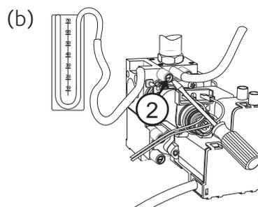
2. Déconnecter le tuyau de compensation de la chambre à air.
