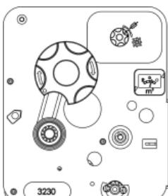
Déclenchement de la régénération par signal externe (contact sec) pendant 6 min. Généralement utilisé sur les vannes des systèmes duplex et triplex.
